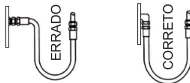
Evite torções ou dobras repentinas usando adaptadores com ângulos corretos.
