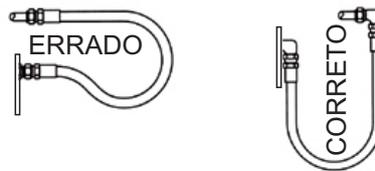
Quando o raio for inferior ao mínimo da mangueira, um adaptador deve ser usado para evitar dobras repentinas na mangueira.
