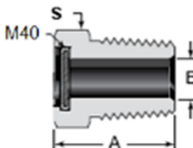
Protege orifícios que necessitem ficar aberto para a atmosfera contra a entrada de sujidades e Insetos que podem entrar em instrumentos, tubos, válvulas de vent, etc.
