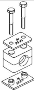
Abraçadeira para tubo de diâmetro externo ..... mm, Standard, com base para solda e placa de cobertura.
